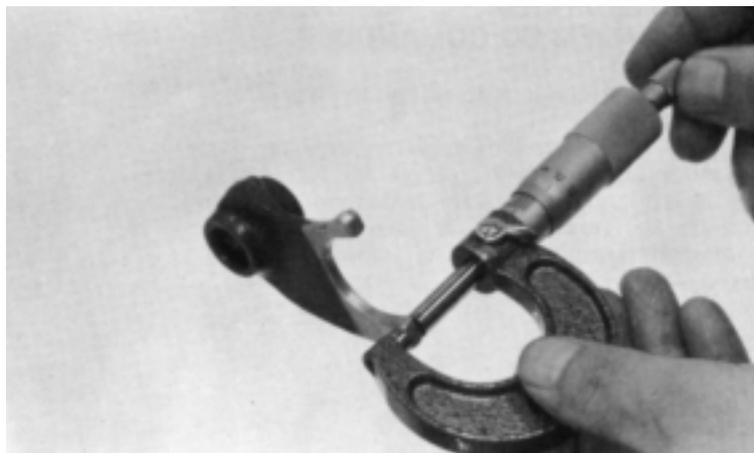
Meça o diâmetro externo do eixo dos garfos seletores em várias posições.
