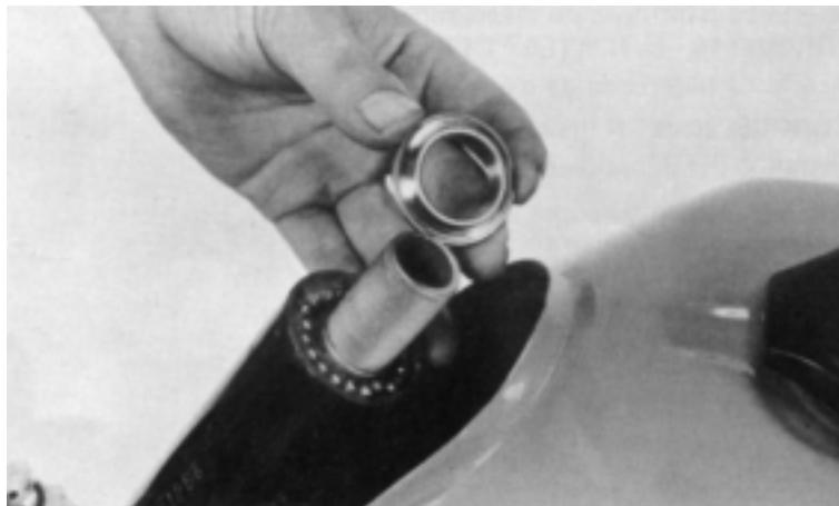
Remova a coluna de direção do chassi.
