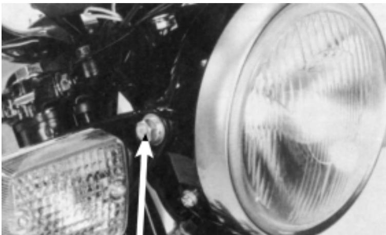
PARAFUSO DE FIXAÇÃO DA CARÇA DO FAROL
