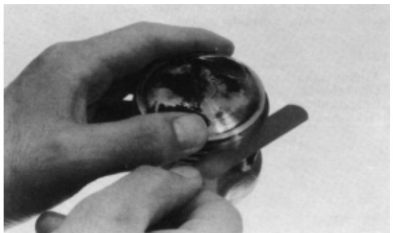
Introduza cada um dos anéis no cilindro e verifique a folga na extremidade dos anéis.
