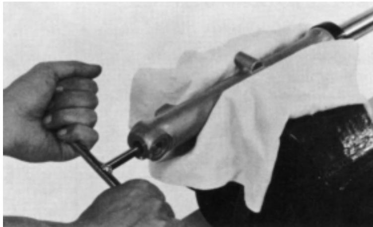
Instale o retentor de óleo na extremidade do cilindro externo com a guia do retentor.
