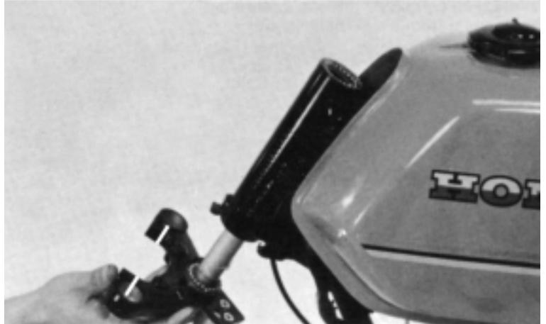
Remova as pistas de esferas com o extrator. Verifique as pistas de esferas quanto a desgaste ou danos e troque-as se necessário.
